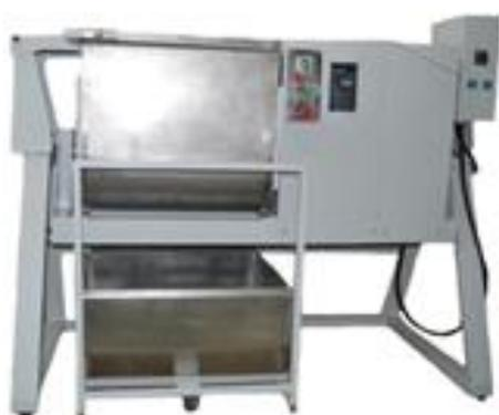
**Машина тестомесильная ТМ-150** – предназначена для вымешивания различных кондитерских масс (сахарное, пряничное тесто, тесто для баранок, сушек). Выгрузка массы осуществляется в заранее подготовленную емкость путем поворота смесителя.
